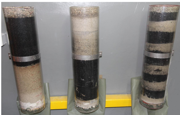
Rys. 1. Model kolumnowy filtra piaskowego z dodatkiem węgla aktywnego (kolumny A, B, C)
