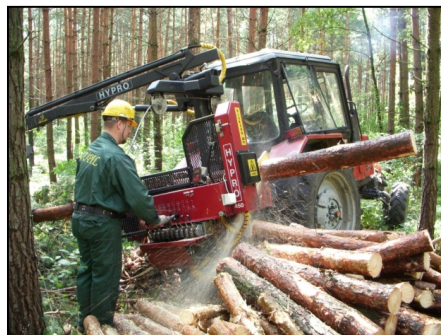
Rys. 2. Procesor HYPRO 450 w trzebieży wczesnej, Leśnictwo Żory, oddział 267d (fot. A. Stańczykiewicz)
