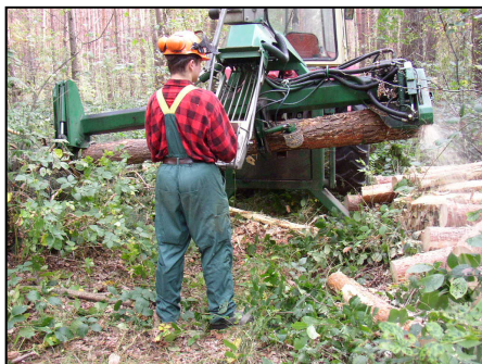
Rys. 1. Procesor NIAB 5-15 w trzebieży późnej, Leśnictwo Waryś, oddział 304d (fot. A. Stańczykiewicz)
