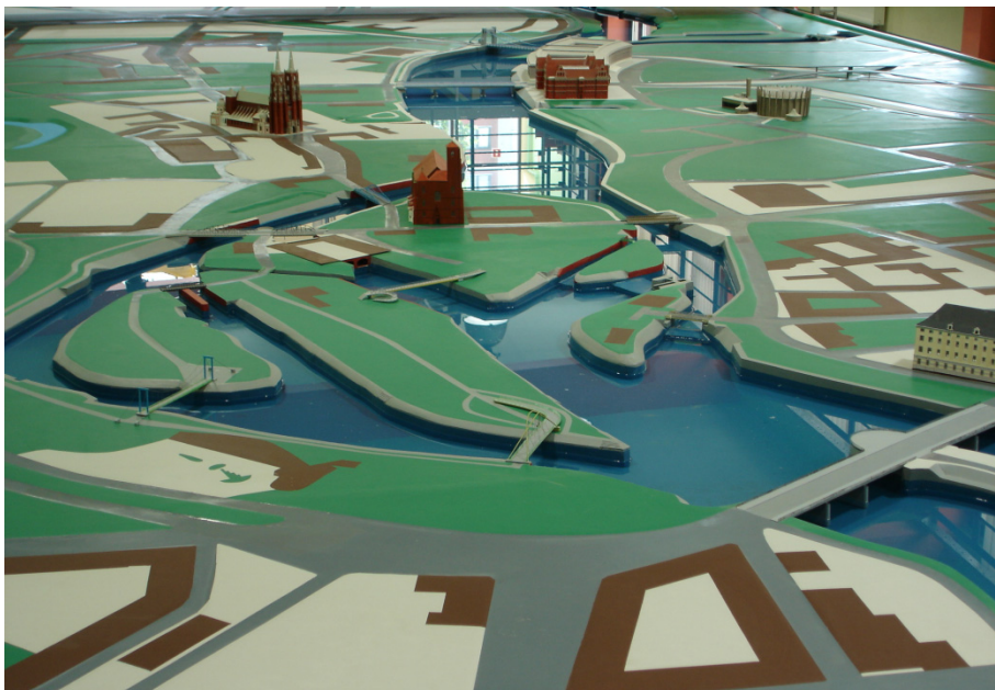
Rys. 4. Wielkogabarytowy model laboratoryjny Wrocławskiego Węzła Wodnego Fig. 4. Large-size laboratory model of Wrocław Hydrotechnical System
