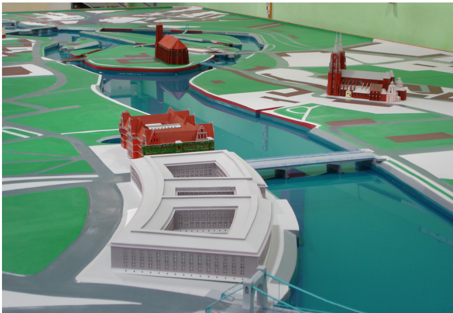
Rys. 3. Fragment modelu hydrowęzła wrocławskiego w Laboratorium Instytutu Inżynierii Środowiska Uniwersytetu Przyrodniczego we Wrocławiu
