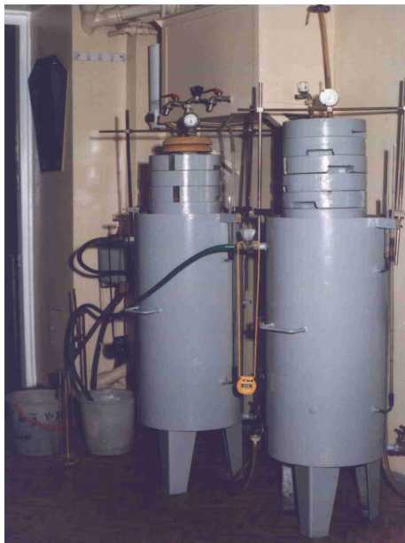
Rys. 1. Aparaty średniowymiarowe do badań współczynnika filtracji (fot. A. Owskiński) Fig. 1. Medium size apparatus for filtration coefficient tests (photo by A. Owskiński)
