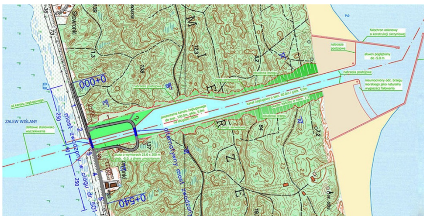
Rys. 2. Plan i zasadnicze budowle kanału żeglugowego przez Mierzę Wiślaną Fig. 2. Scheme and main object of the navigation channel across the Vistula Spit
