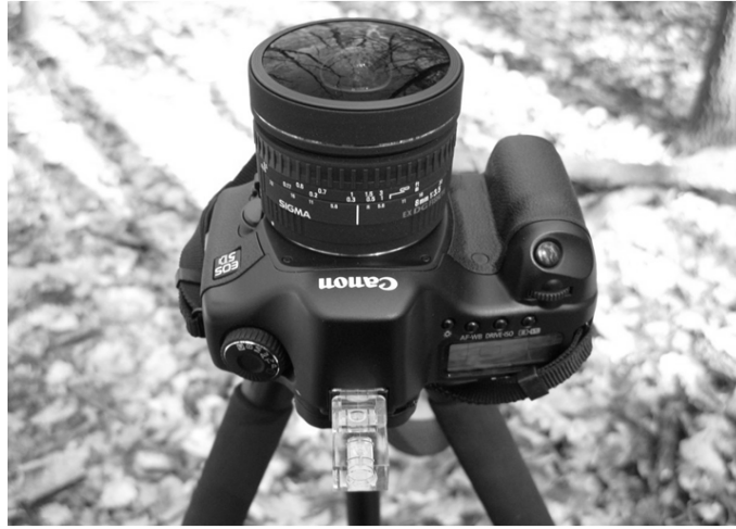
Rys. 3. Metoda wykonywania zdjęć hemisferycznych Fig. 3. Method of taking hemispherical photos
