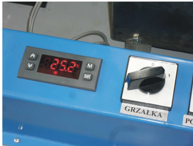
Fig. 2. Electronic oil temperature controlling system Rys. 2. Elektroniczny układ sterowania temperaturą oleju
