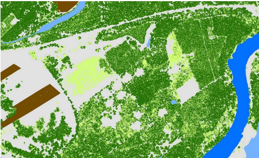
Rys. 6. Przypisanie współczynników szorstkości Manninga – wizualizacja rastra 1 \times 1 m Fig. 6. Application of Manning's roughness coefficients – raster visualization 1 \times 1 m
