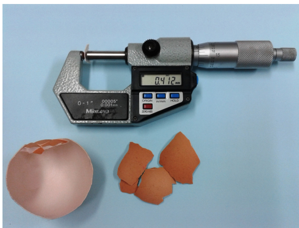
Rys. 1. Pomiar grubości skorupy za pomocą mikrometru Mitutoyo (Japonia) (fot. L. Lewko)
