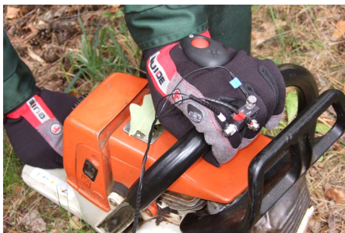
Rys. 3. Miejsce mocowania czujnika drgań Fig. 3. Location of vibration sensor attachment
