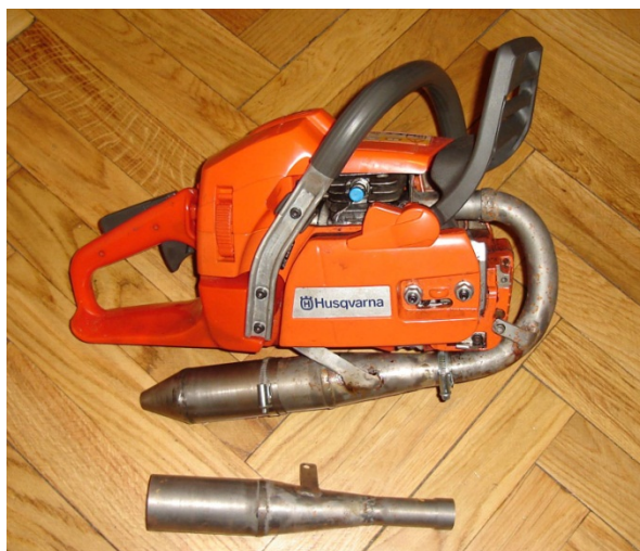
Rys. 1. Pilarka spalinowa Husqvarna 357XP ze zmodyfikowanymi układami wydechowymi (HAŃKOWSKI 2007)
