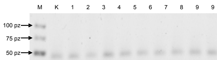
Rys. 5. Elektroforetyczny rozdział produktów reakcji PCR ze starterami BCgr1F/BCgr1R1K; M – marker O'Gene Ruler DNA Ladder Ultra Low Range, K – kontrola dodatnia – Carnobacterium divergens AS7, 1-9 – próby oscypka
