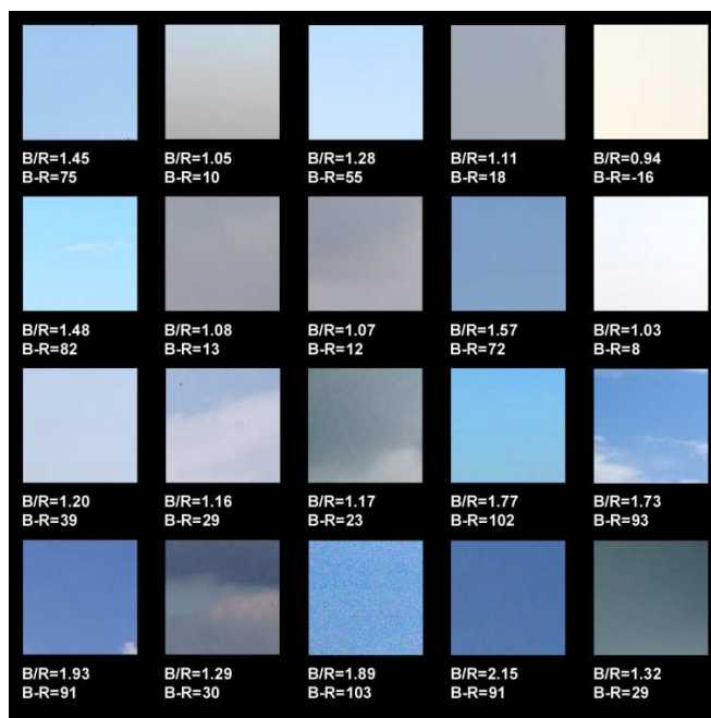
Rys. 4. Wybrane próbki tła (nieba) wraz ze współczynnikami korelacji kanałów barwnych B i R (fot. A. Ozimek)
